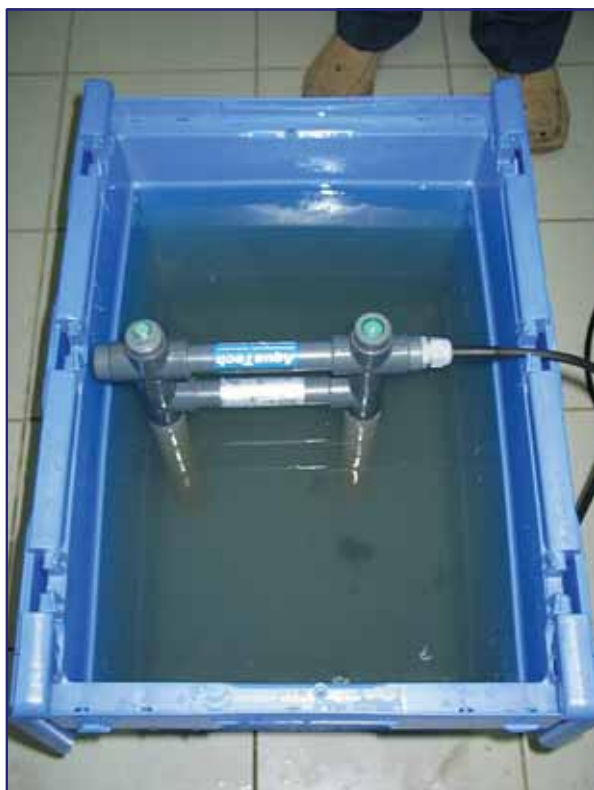
Urządzenie do ogłuszania ryb przed wpuszczeniem karpia handlowych.
